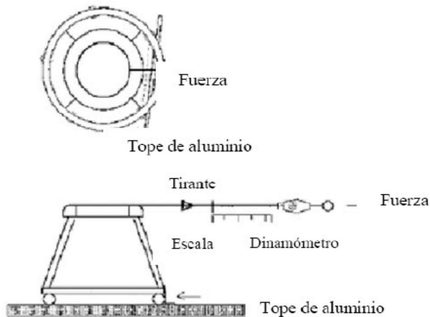
FIGURA.- 4 CONFIGURACIÓN PARA LA PRUEBA DE RESISTENCIA
