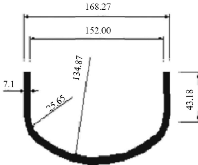
FIGURA. 2 - CÁPSULA DE SOLDAR DE 152 mm Y 2,9 kg
