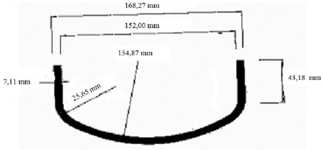
Figura 3.- Cápsula de soldar de 152 mm y 2.90 kg.
