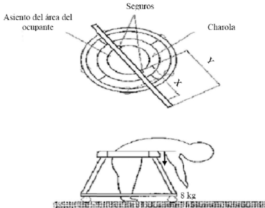
FIGURA.- 6 ARREGLO PARA LA PRUEBA DE INCLINACIÓN
